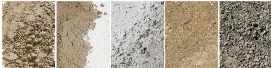
Solo antes (à esquerda) e após (à direita) mistura com a cal (Graymont, 2016)
